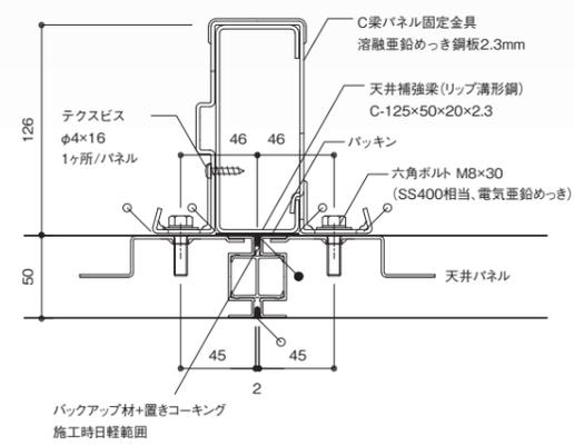
天井補強梁部詳細図 (C梁仕様)
