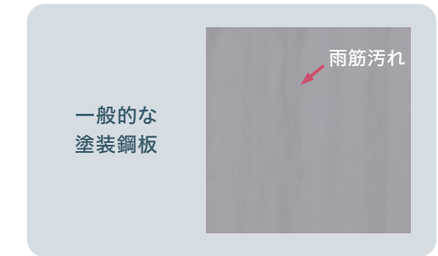
上記は雨筋汚染試験を1ヵ月間行った写真です。試験は汚れが付きやすい条件で行っています。
