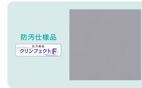
上記は雨筋汚染試験を1ヵ月間行った写真です。試験は汚れが付きやすい条件で行っています。
